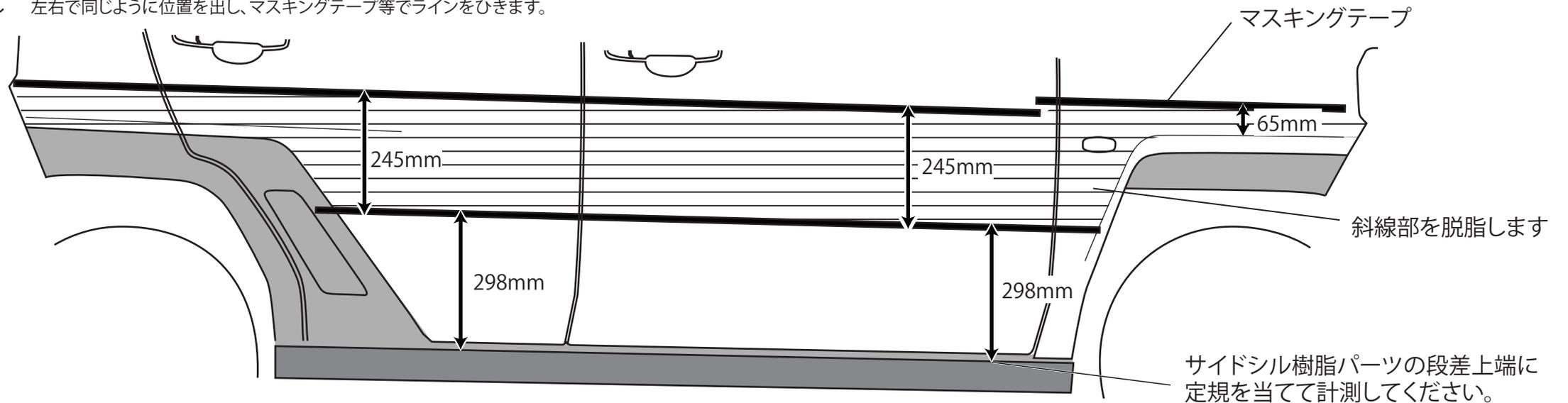
**図2** ステッカーの貼り付け ※ドアパーティングからの距離は全箇所約2mm
