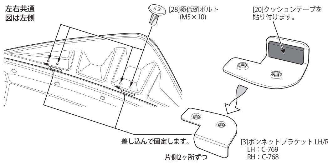
③ボンネットカバーを車両ボンネットの仮合わせした位置に載せてからボンネットブラケットを仮締めして、両面テープの剥離紙を引き抜いて圧着させます。最後にボンネットブラケットのボルトを本締めしてください。
