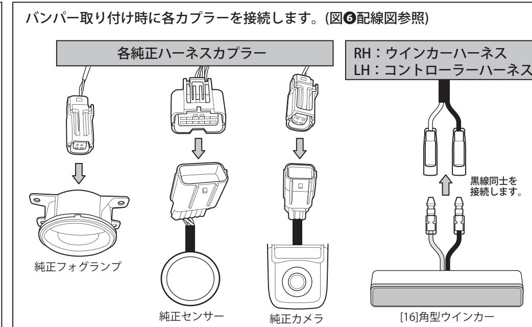
※バッテリーの(-)端子を接続後、ランプ類、センサー、カメラの動作確認を必ず行ってください。
