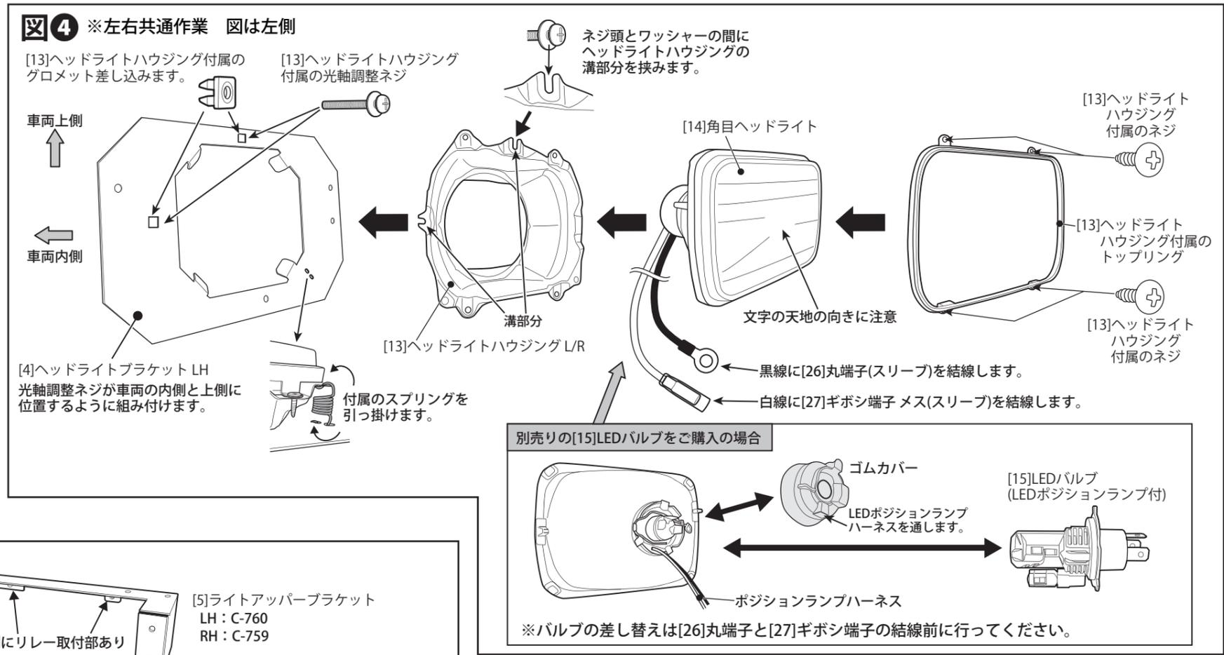
手順5. 下図を参考に、各ブラケットを車両に組み付けてからヘッドライトASSYを取り付けます。
