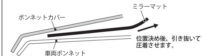
③ボンネットカバーを車両ボンネットの仮合わせした位置に載せてからボンネットブラケットを仮締めして、両面テープの剥離紙を引き抜いて圧着させます。最後にボンネットブラケットのボルトを本締めしてください。
