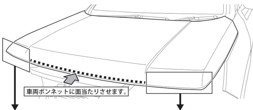
②次に各両面テープの剥離紙を2~3cm程剥がして外側に出し、マスキングテープで止めておきます。
