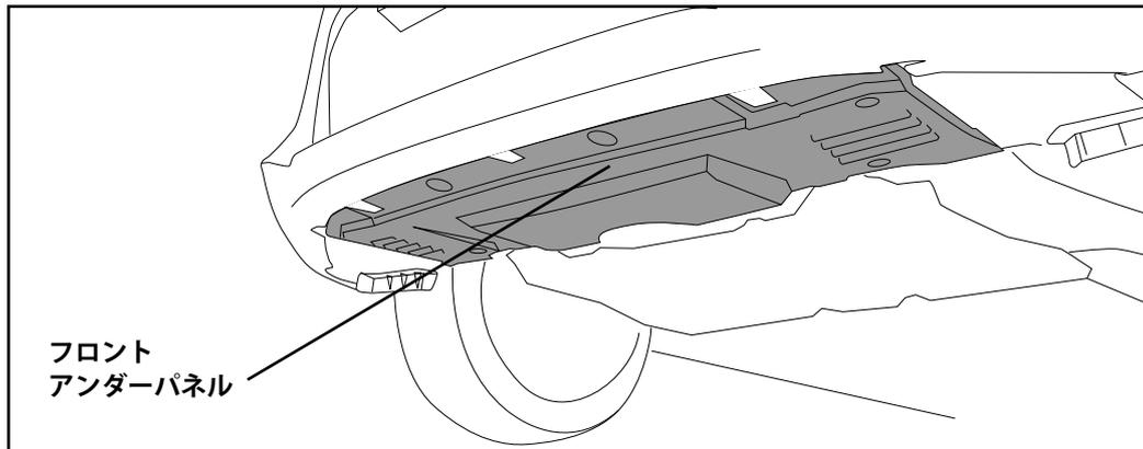
〈5〉 クリップ留めした2箇所以外の、穴位置5箇所(下図矢印の箇所)に7mm径でバンパー側に穴開けし、付属ボルト・ナット等にて固定します。
