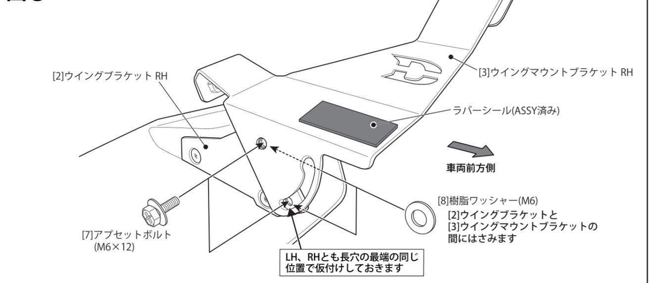
手順2. [1]リアウイングに[2]ウイングブラケット LH/RHを取り付けます。以下リアウイングASSY
