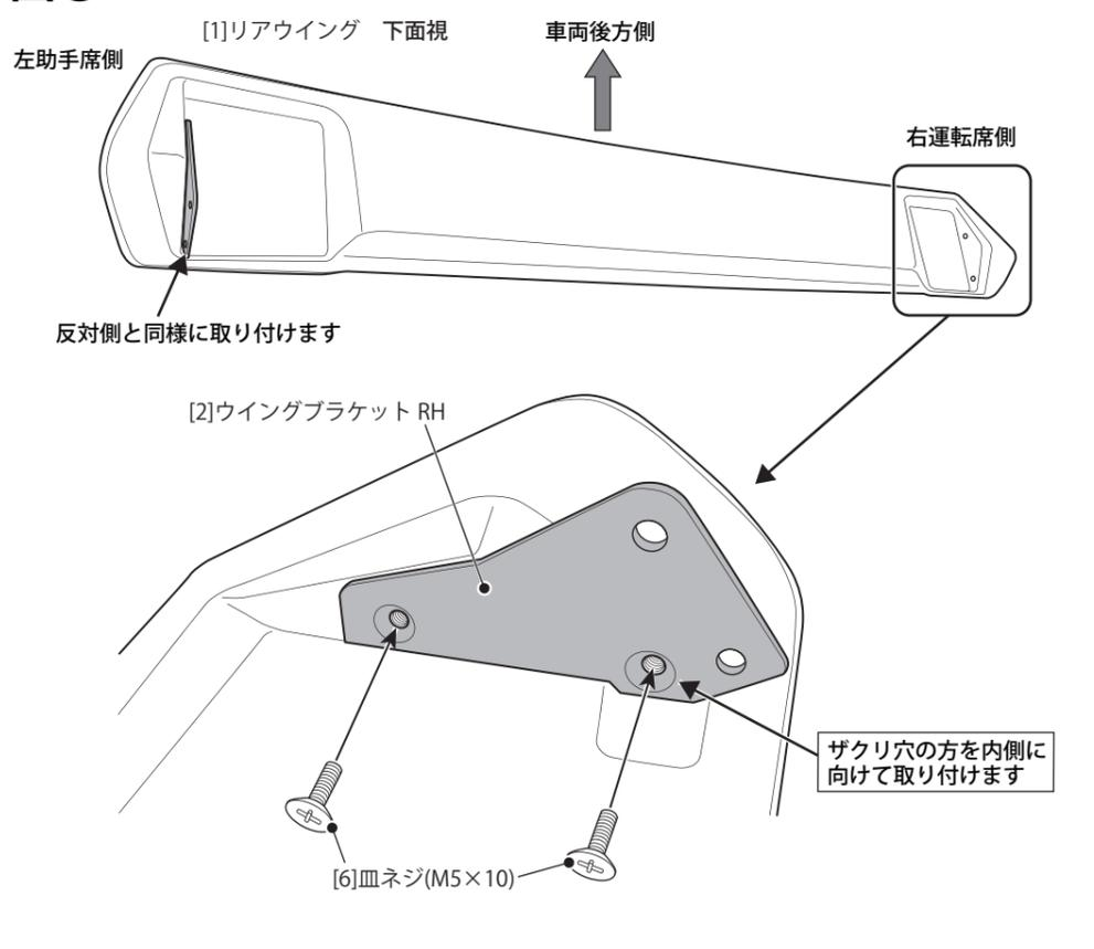
手順4. リアウイングASSYを車両に取り付けます。ウイングの角度を決めて各ボルトを本締めして完成です。
