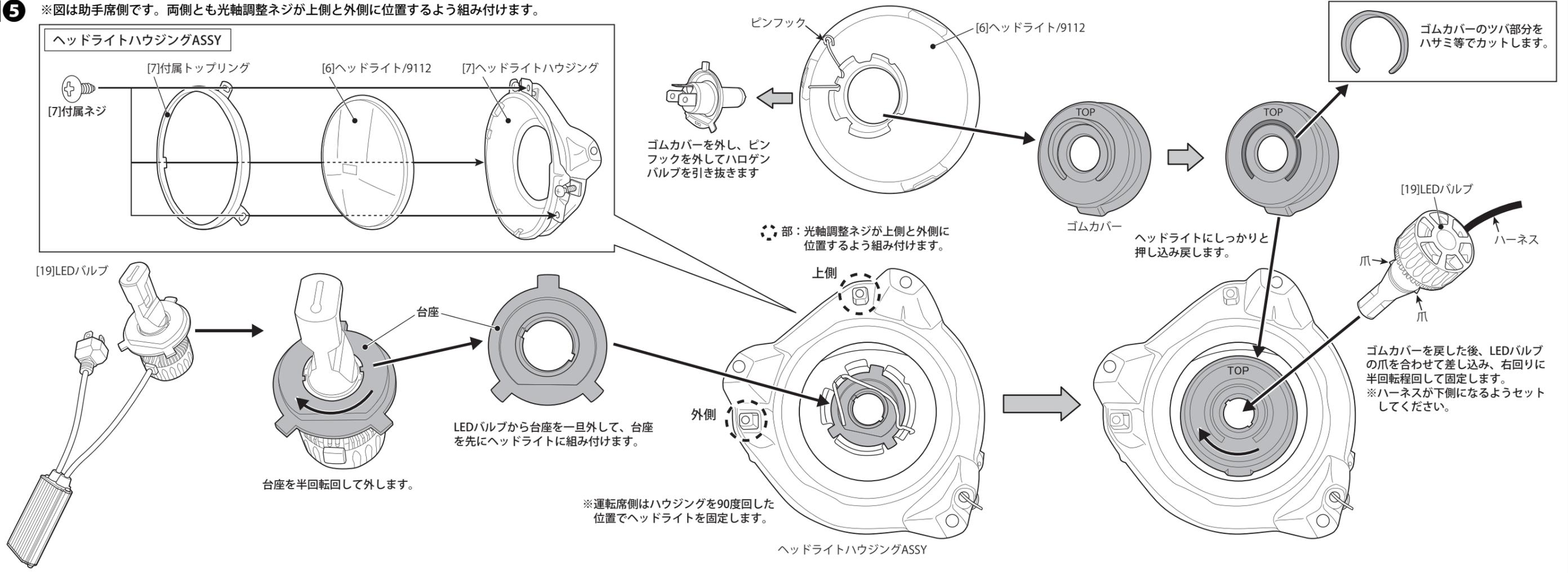
手順6. 図6を参考に、ヘッドライトのLEDハーネスに[9]ヘッドライトハーネスLED用をヘッドライトに接続します。また、ギボシ端子メスを[11]ポジション用ハーネスのギボシ端子オスに接続します。
