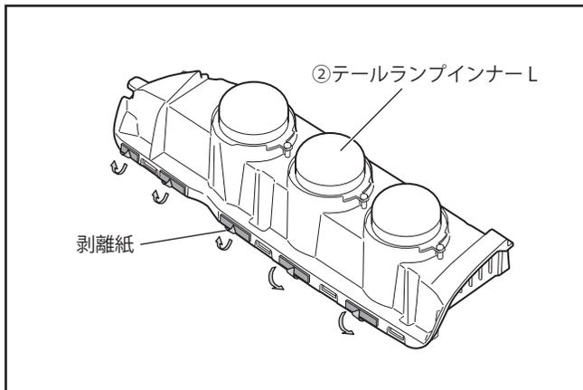
**6** 両面テープの剥離紙を引き抜いてテールランプインナーとテールランプアウターを圧着します。
